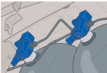
elektromagnetische Absperrventile an den Gastanks
