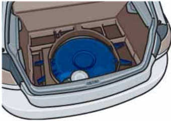
Der Flüssiggastank in der Reserveradmulde
