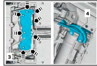
Ventil am Gastank Nr.3 in Pfeilrichtung mit Handrad -T50026- (ŠKODA Spezialwerkzeug) oder einer Zange schließen.
