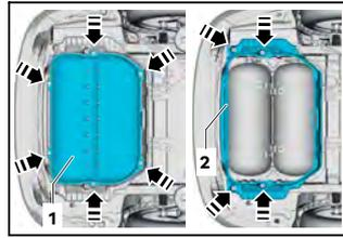
Ventil am Gastank Nr.2 in Pfeilrichtung mit Handrad -T50026- (ŠKODA Spezialwerkzeug) oder einer Zange schließen.
