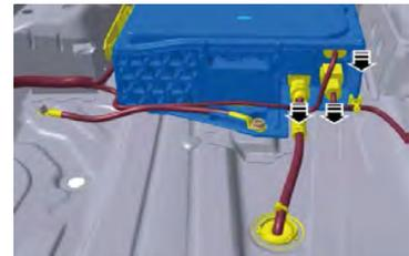
Bei Unfällen mit Airbagauslösung wird das 48V-Bordnetz automatisch deaktiviert.
