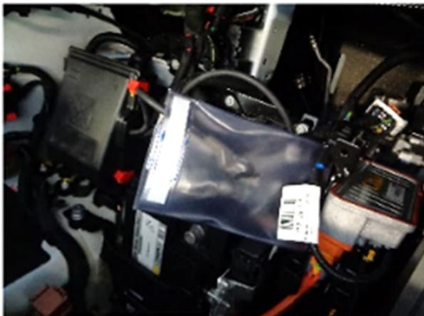
**6** Trennen Sie die 3 Leistungssteckverbinder von der HV-Batterie
