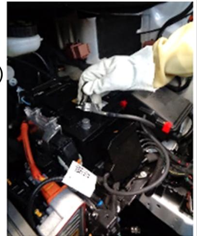
**5** Schützen Sie den positiven Ring mit einem Sicherheits-Isolierbeutel
