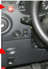
Bedienelement zum Öffnen der Ladeklappe
