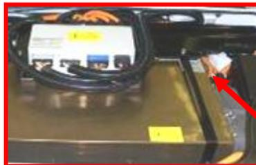
2 Abklemmen der Batterie durch Entfernen der beiden Steckverbinder am Steuergerät der Antriebsbatterie Z37.
