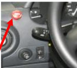
1 Not-Aus-Taster links neben dem Lenkrad betätigen
