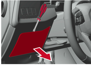
Linkslenker (neben der Lenksäule) Abdeckung entfernen
