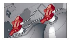
► Jeder Gastank besitzt ein eigenes Flaschenventil mit einem manuellen Absperrhahn.
