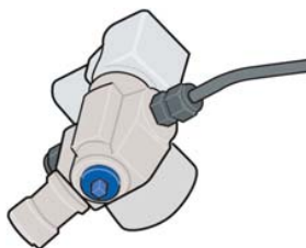
manueller Absperrhahn am Fuß des Flaschenventils.
