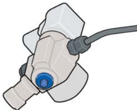
manueller Absperrhahn am Fuß des Flaschenventils.
