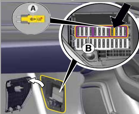
1. Sicherungskastendeckel in dem Beifahrerfußraum rechts öffnen.
