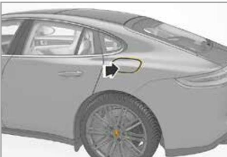
**Fahrzeugladeanschluss** hinter der Ladeklappe am Fahrzeug hinten links
