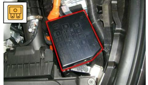
2. Dargestellte Sicherungen im Kastendeckel entfernen.
