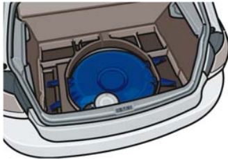
Der Flüssiggastank in der Reserveradmulde
