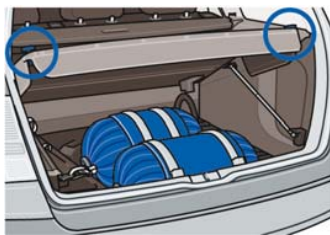
die Gastanks unter dem Ladeboden
