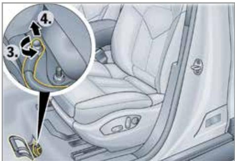
3. Das Massekabel der 12-Volt-Batterie an der Schraubverbindung trennen (-3-).
