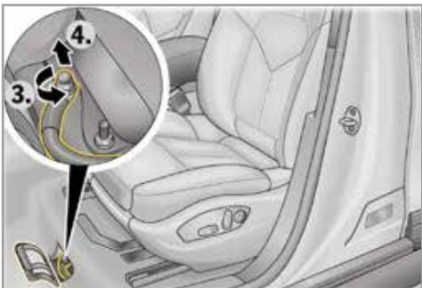
3. Minuskabel der 12-Volt-Batterie an der Schraubverbindung lösen (-3-) und gegen ungewollten Kontakt sichern (-4-).
