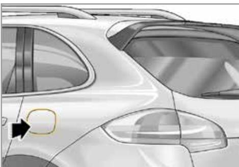
**Fahrzeuginnenanschluss** hinter der Ladeklappe am Fahrzeug hinten links
