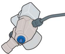
manueller Absperrhahn am Fuß des Flaschenventils.
