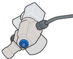
manueller Absperrhahn am Fuß des Flaschenventils.
