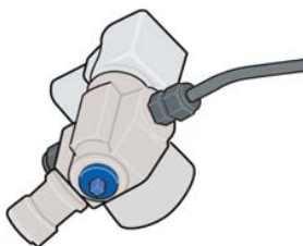
manueller Absperrhahn am Fuß des Flaschenventils.
