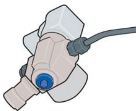
manueller Absperrhahn am Fuß des Flaschenventils.
