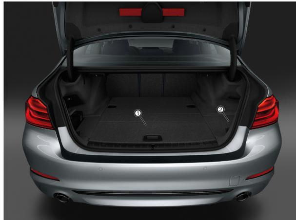
Batterieminusleitung (1, 2) lösen und nach oben abziehen.
