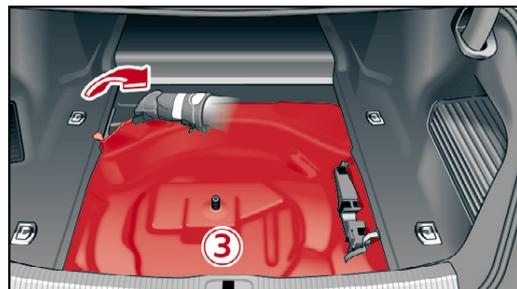
4. Plastikabdeckung 48V-Batterie entfernen, dazu die drei Plastikstifte mit Schraubendreher entfernen
